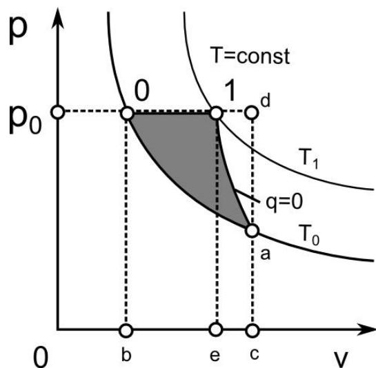
На рисунке изображён процесс перехода термически неравновесной системы в равновесное состояние при постоянном давлении  $p_0$  за счёт перепада температур  $T_1 > T_0$ . Точка 1 представляет собой начальное состояние источника работы; точка 0 соответствует параметрам среды  $p_0, T_0$ .
